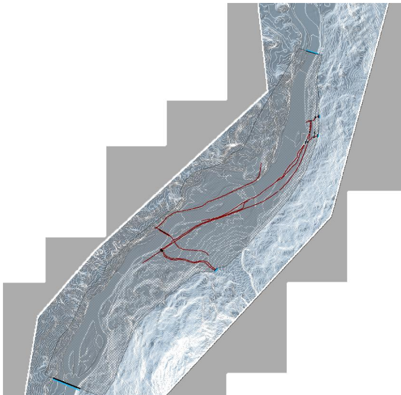
Figur 4-2: Modelloppsett med terrengkonturer, 2D-nett og brytelinjer.
