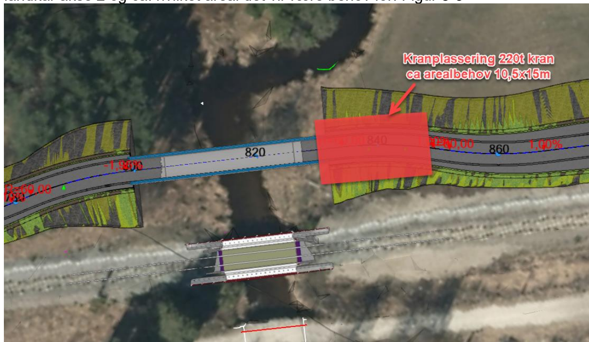
Figur 5-3 – Illustrasjon fra Trimble-modell med kran plassert bak landkar akse 2 (NØ)
